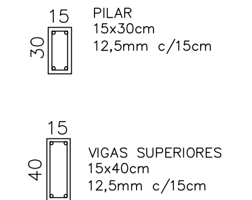
DETALHAMENTO PILARES E VIGAS SUPERIORES ESCALA 1:25
