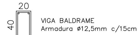
VIGA BALDRAME Armadura Ø12,5mm c/15cm DETALHAMENTO VIGA BALDRAME E SAPATA ISOLADA ESCALA 1:25
